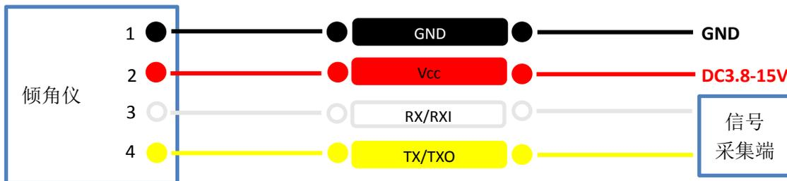
AT304-232/TTL-XB 电气连接示意图：
